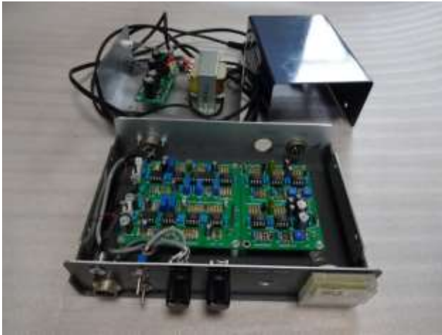
⑱ 1 RS-LB3 マイク、リミッティングアンプ半完成品。 ノイズゲート、ツートーンあり。 基板は完成、調整済み
