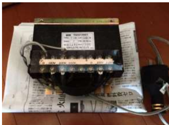
⑫ 200V→100V電圧変換トランス
