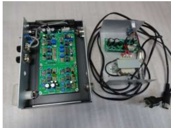
⑱ 1 RS-LB3 マイク、リミッティングアンプ半完成品。 ノイズゲート、ツートーンあり。 基板は完成、調整済み
